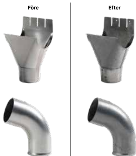
Exempel på detalj exponerad ca 6 år i korrosivitetsklass C3.
