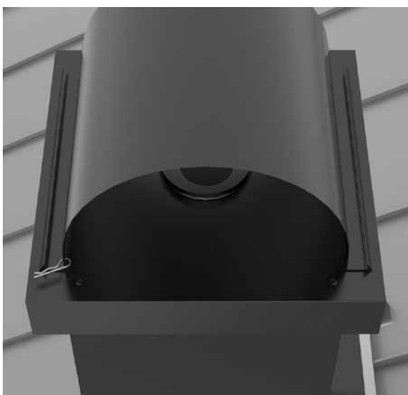
19. Skjut vindtunneln i skenorna, säkra med fjädersprint. (Taket med vindtunneln kan vändas som man vill beroende på väderstreck)
