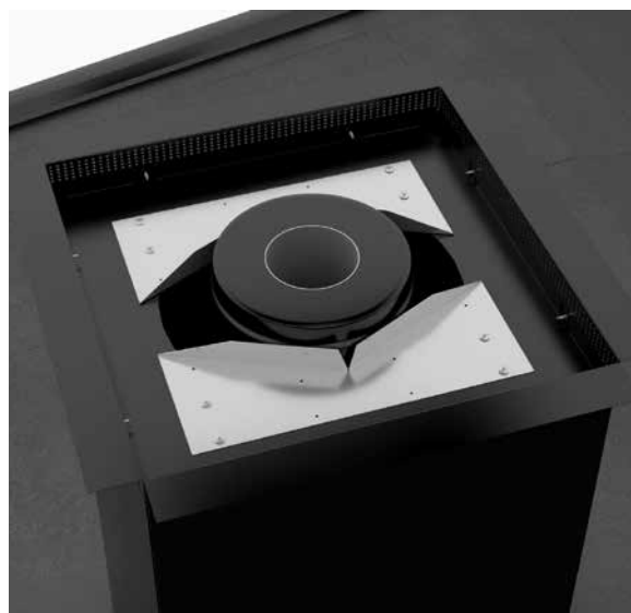
16. Montera 2 st mantelstöd i översta rörhållaren med 8 st montageskruv 4,2×25.
