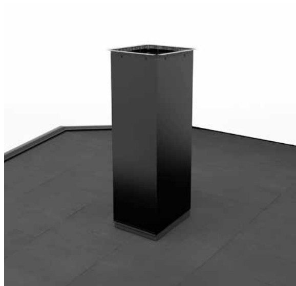
14. Sätt på stosen. Lämna 50 mm synligt av pappen i underkant.
