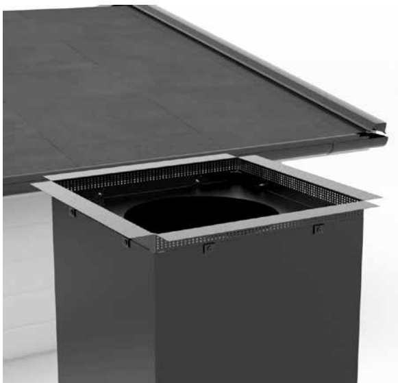
13. Montera den övre rörhållaren till stosen med 8 st LP-skruv 4,8×20.
