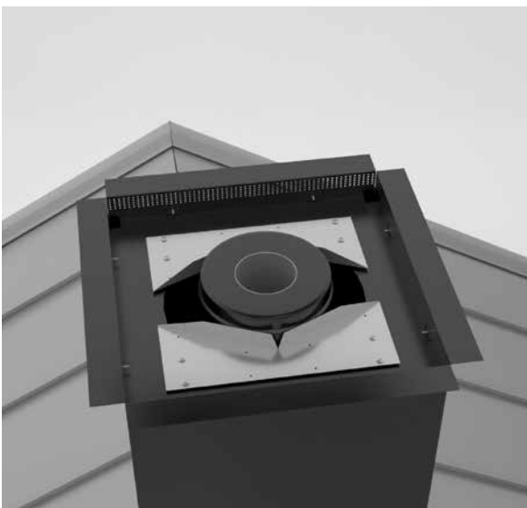
21. Montera 2 st mantelstöd i översta rörhållaren med 8st montageskruv 4,2×25.
