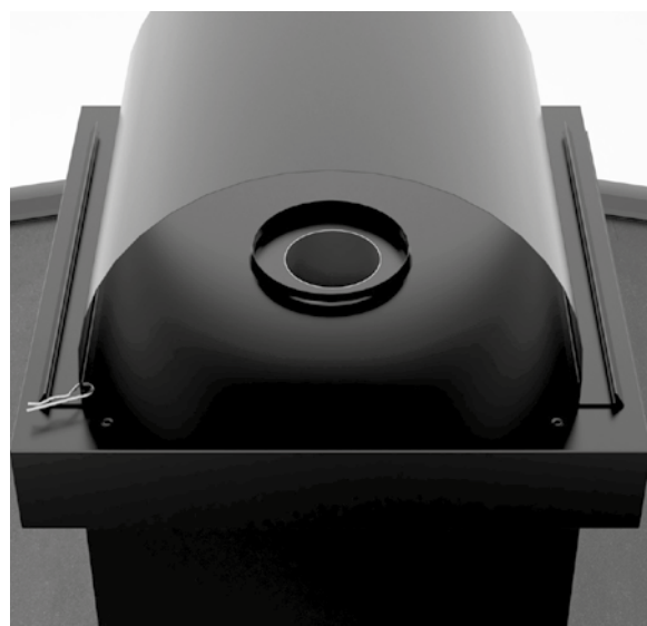
21. Skjut vindtunneln i skenorna, säkra med fjädersprint. Taket med vindtunneln kan vändas som man vill beroende på väderstreck.
