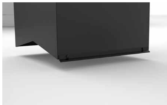
14. Montera frontlisterna med 2 st LP-skruv 4,8×20 i varje list.
