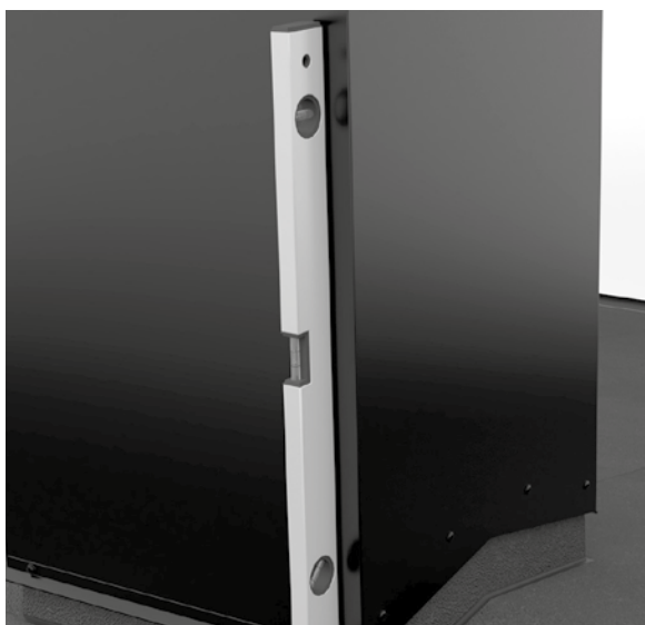
17. Kontrollera med vattenpass att det är lodrätt och skruva fast stosen i sidorna med 8 st LP-skruv 4,8×35.
