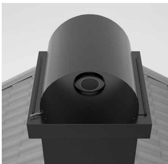
22. Skjut på vindtunneln i skenorna, säkra med fjädersprint. (Taket på vindtunneln kan vändas som man vill beroende på väderstreck)
