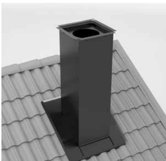
15. Skjut stosen utanpå överbeslaget, kontrollera med vattenpass att det är lodrätt och skruva fast stosen i sidorna med 8 st LP-skruv 4,8×35.
